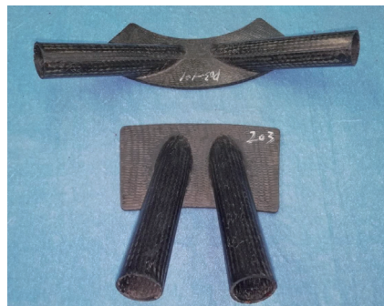
碳/环氧编织复合材料发动机支架
